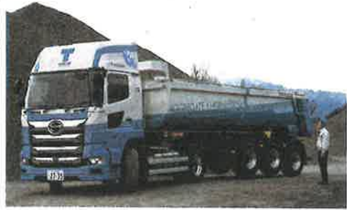
最大積載量28・9トのトレーラーダンプ。骨材の輸送に使う
