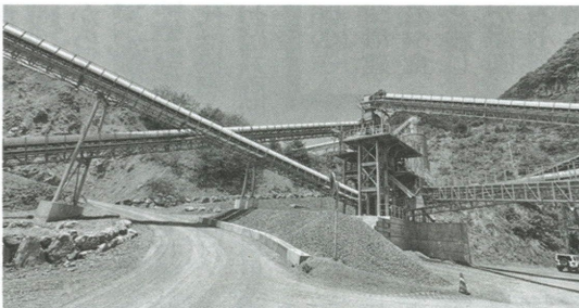
大芝鉱山の新社砕砂ラインの一部。高耐候性を図るため、コンベア・架台等の金属資材にはすべて亜鉛メッキ加工を施した
